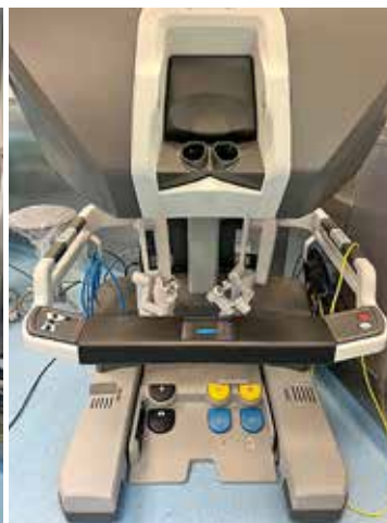
Konsola chirurgiczna – serce systemu i miejsce pracy operatora
